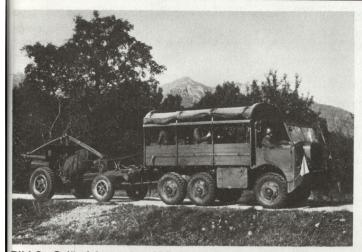
Bild 9. Geländelastwagen M 6 mit 10,5 cm Sch Mot Kan
