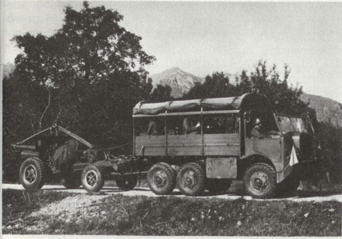
Bild 9. Geländelastwagen M6 mit 10,5 cm Sch Mot Kan
