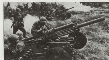
Automatischer 82-mm-Minenwerfer VASILYOK in Schussposition.
