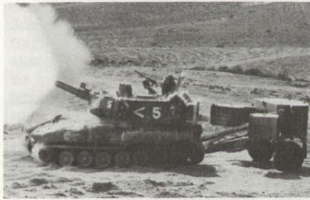
Mittels eines Förderbandes zwischen Anhänger und Panzerhaubitz kann die Munition mit einer Geschwindigkeit von etwa fünf Schuss pro Minute in den Kampfräum transportiert werden.
