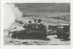
Mittels eines Förderbandes zwischen Anhänger und Panzerhaubitze kann die Munition mit einer Geschwindigkeit von etwa fünf Schuss pro Minute in den Kampf-
