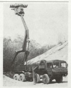
Waffensystem HOT/EPLA (Elevierbare Plattform) auf einem schweren Geländelastwagen MAN mit Elevationseinrichtung und Kampfplattform mit sechs PAL HOT.
