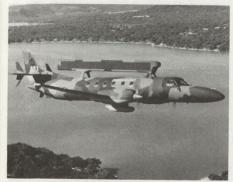
Mit dem System ASGC werden Radarsignale an Bord gerechnet und mittels Data link an bodengestützte Kontroller übermittelt. Die Einsatzdauer in dieser Konfiguration mit dem Trägerflugzeug Fairchild Metro III (siehe Bild), liegt zwischen 4 bis 6 Stunden mit einer Reichweite von ungefähr 185 km. Das System ASAC ermöglicht autonome Einsätze. Das Trägerflugzeug Saab SF 340 ist für 4 Operateure ausgerüstet und ermöglicht eine Einsatzdauer von 7 bis 9 Stunden über eine Reichweite von ungefähr 185 km.
