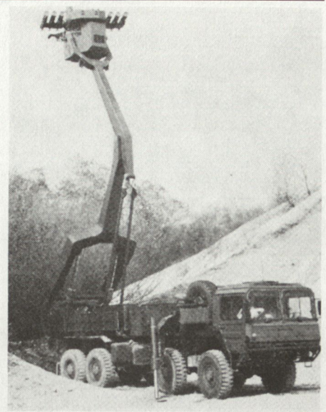
Waffensystem HOT/EPLA (Elevierbare Plattform) auf einem schweren Geländelastwagen MAN mit Elevationseinrichtung und Kampfplattform mit sechs PAL HOT.
