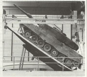
Prüfung des integrierten Gesamtsystems in Schräglage.
