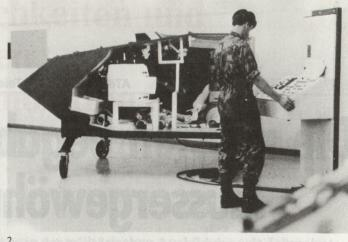
Bild 1. Die Ausbidungsanlage «Turm» ermöglicht die Handhabung aller Bedienteile an den Gefechtsplätzen von Kommandant, Richter und Lader.
