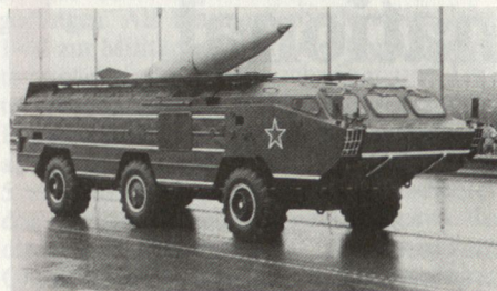
Taktisches Lenkwaffensystem SS-21 SCARAB auf dreiaxsigem Radfahrzeug ZIL-5937. Zu jedem Abschussfahrzeug gehören ein bis zwei Nachladefahrzeuge mit je 2 Lenkwaffen.
