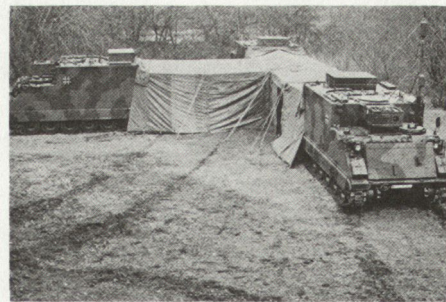
Sternförmig aufgebautes Führungssystem eines Divisionsgefechtsstandes. Die einzelnen Kommandoschützenpanzer M-577 enthalten die verschiedenen Zellen der Führungsmittel.
