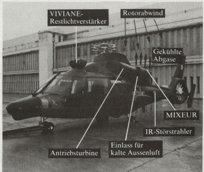
Bild 2. Seitenansicht der «Panthère». Mixeur hinter dem Turbinenteil.
