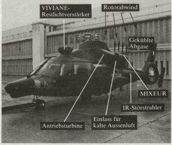
Bild 2. Seitenansicht der «Panthère». Mixeur hinter dem Turbinenteil.
