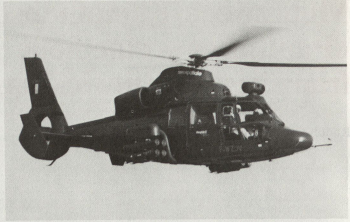
Bild 4. «Panthère» mit acht HOT-Panzerabwehr lenk waffen.
