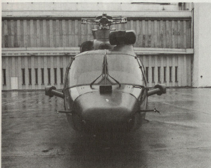
Bild 1. Vorderansicht des 365M «Panthère»-Kampfhubschraubers mit abgenommenen Starflex-Rotorblättern. Beidseitig des Rumpfes die Waffenkonsolen; VIVIANE-Restlichtverstärker auf dem Rumpfdach.
