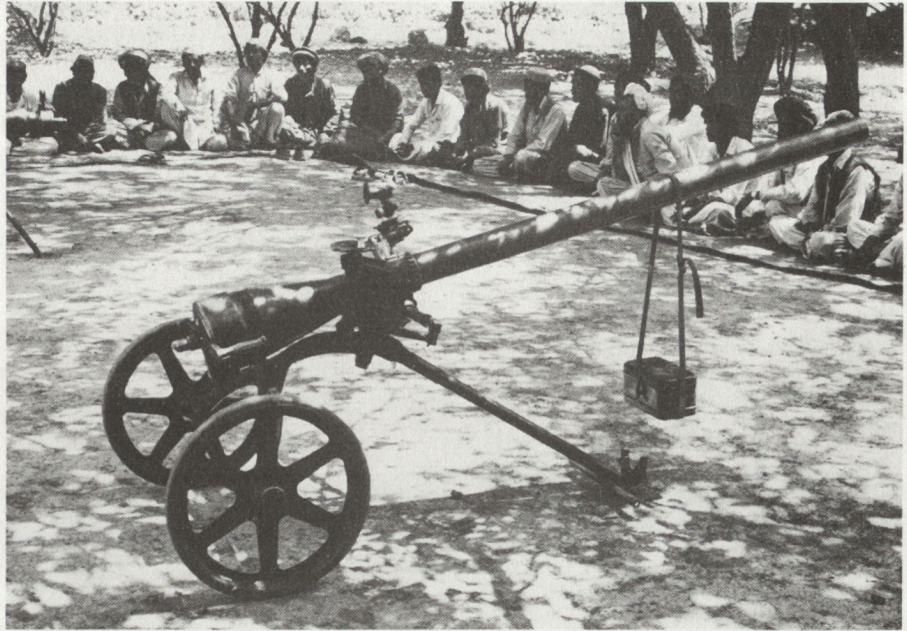
Foto 10: Rückstossfreie Panzerabwehrkanone, Kaliber 73 mm / A. Stahel
