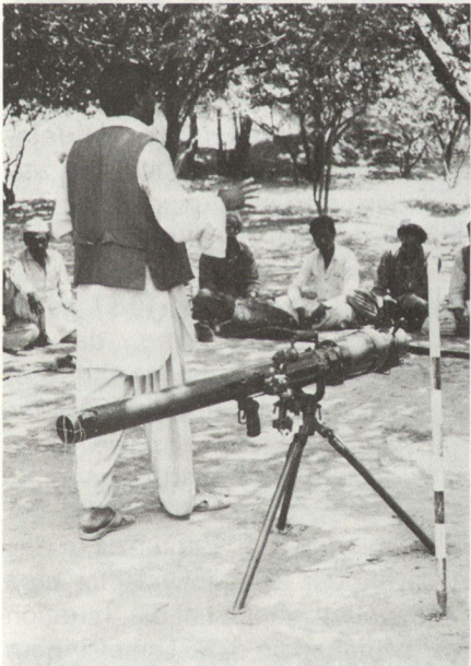
Foto 11: Rückstossfreie Panzerabwehrkanone, Kaliber 82 mm / A. Stahel
