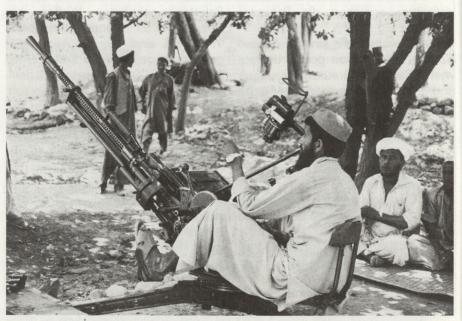
Foto 8: Flab-Maschinengewehr 14,5 mm ZPU 1 / A. Stahel
