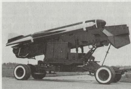
Grundversion der HY-2 SILKWORM auf einer mobilen Abschusslafette.
