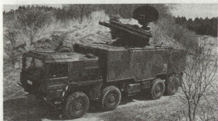
Neue Roland-Version auf Geländelastwagen. Dieses vollautonome Tiefflieger-Abwehrsystem hat eine maximale Reichweite von 8 Kilometern.
