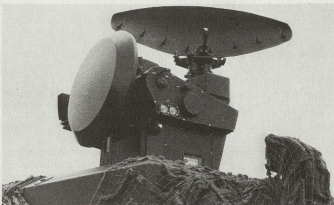
Der Suchradar des SKYGUARD (oben) liefert jede Sekunde eine Luftlagekarte im Umkreis von 15 km. Bei Auftauchen eines Gegners übernimmt der Folgeradar (unten) die Bekämpfung.
