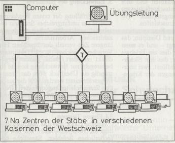
Abb. 1: Übungsanlage; Betrieb von abgesetzten Terminals
