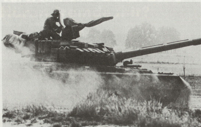
Bild 2a. T-80 mit Reaktivpanzerung (Soviet Military Power 1987).
