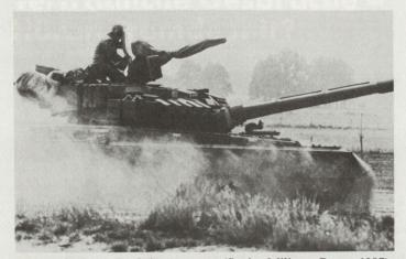
Bild 2a. T-80 mit Reaktivpanzerung (Soviet Military Power 1987).
