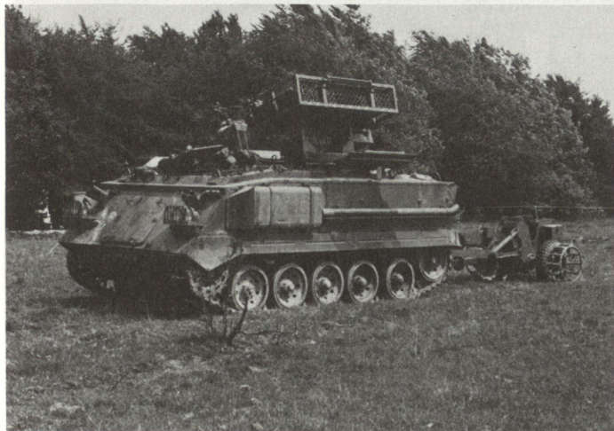
Bild 4a. Mittel zur Schnellverminung, das englische Minenwurf-system «Ranger Barrier Defense System» und das «Bar Mine»-Schnellverminungsgerät (L. F. Carrel).
