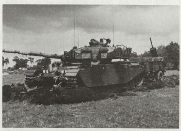
Bild 4b. Schnellentminungssysteme: englischer Minenräumpflug kombiniert mit Sprengschlange «Giant Viper Minefield Breaching System» (L. F. Carrel).
