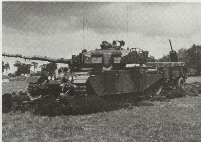
Bild 4b. Schnellentminnungssysteme: englischer Minenräumpfzug kombiniert mit Sprengschlange «Giant Viper Minefield Breaching System» (L. F. Carrel).
