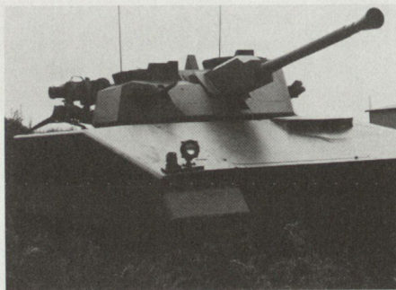
Modell des Stridsfordon 90, ausgerüstet mit Automatenkanone 40 mm von Bofors (Grundversion Kampfschützenpanzer).
