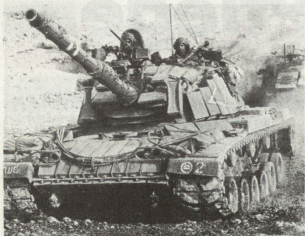
Israelischer Kampfpanzer M60 mit «Blazer-Reaktivpanzerung»
