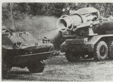
Entgiftung eines Aufklärungsschützenpanzers BRDM-2 mit Dekontaminierungsgerät TMS-65 (auf Lastwagen URAL).
