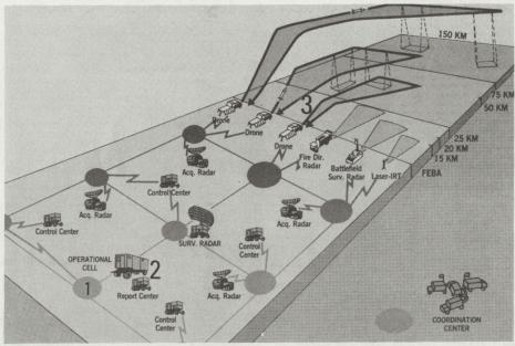
Schematische Darstellung mit: 1) SOTRIN, 2) SOATCC, 3) SORAO
