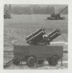
vierteiligen Abschusslafetten befindet sich die Such- und Erfassungsradaranlage sowie die elektro-optische Anlage inklusive Laser für das Lenksystem. Die Radarerfassungsreichweite soll über 20 Kilometer und die maximale Einsatzdistanz der Lenkwaffen im Einsatz gegen Luftziele zirka 8 Kilometer betragen.
