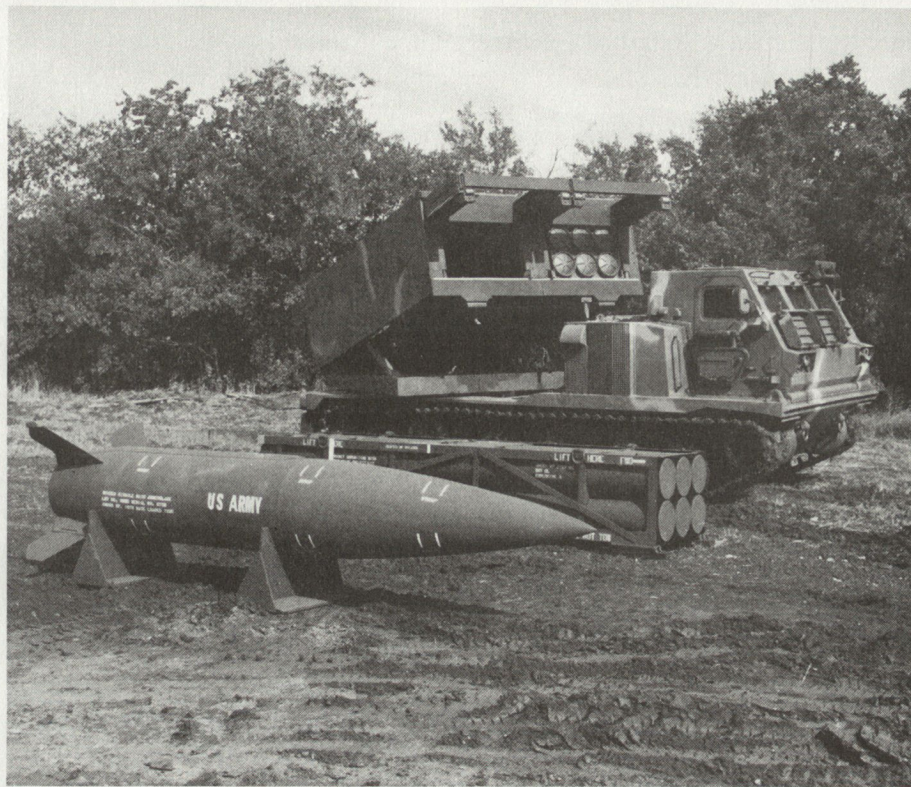
Bild 5. MLRS (LTV) mit Raketenbehälter und Artillerierakete (links).
