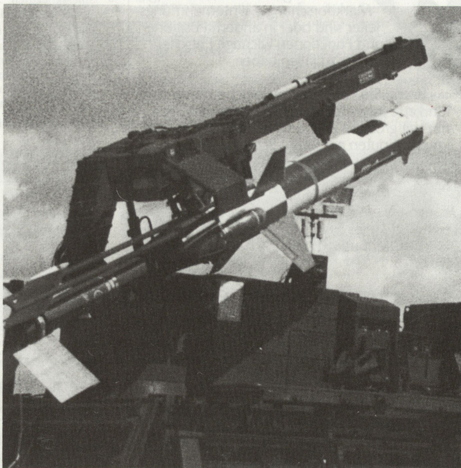
Bild 7: Drohne mit Raketenantrieb (Canadair/Dornier) auf Startrampe.
