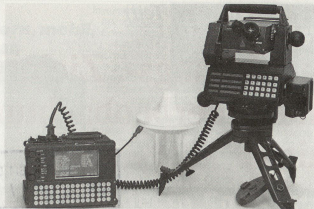
Bild 2: Modernes Zielortungsgerät TAS 10 (Wild Heerbrugg) mit augensicherem Laser, gekoppelt mit einem GPS-Empfänger und Datenübertragungsgerät (Magnavox), einbaubar in Schützenpanzer. Das aufsteckbare Wärmebildgerät fehlt.
