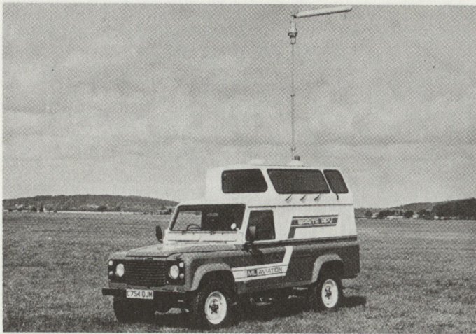
Bild 5: Einfache Bodenstation des Drohnensystems «Sprite» (Loral), mit Navigationsanlage und Bedienkonsolen für 2 Mann.
