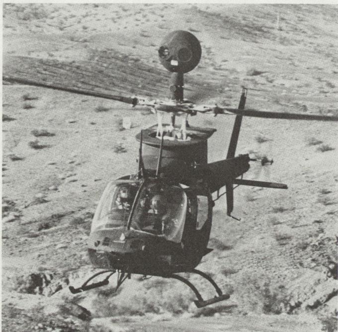
◀ Bild 3: Beobachtungs-Helikopter mit stabilisiertem MMS-Zielortungsgerät. Artillerist rechts im Bild (McDonnell Douglas/ Northrop)
