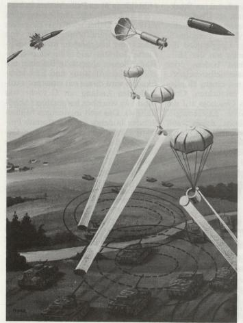
Bild 3. Funktionsprinzip von Suchzündermunition.
