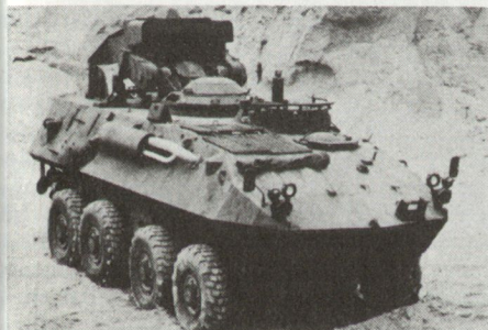
Bild 3. Raketenjagdpanzer LAV-AT mit dem Drehturm für das PAL System TOW.
