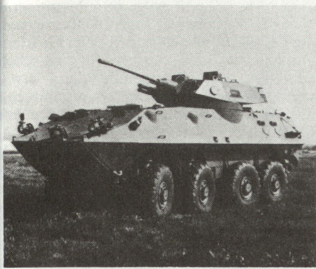
Bild 1. Schützenpanzer LAV 25, Grundmodell 8x8 mit 25-mm-Kan für 3+6 Mann.
