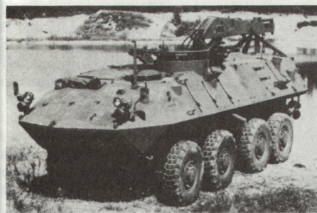
Bild 4. Bergepanzer LAV-R für alle Einheiten des LAAB.
