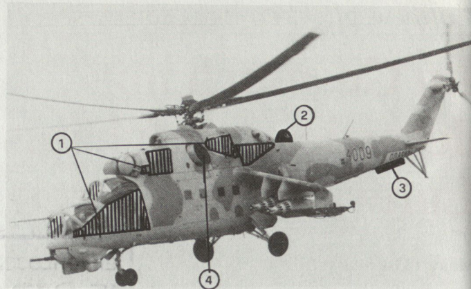
Der Mi-24 HIND-D ist teilweise gepanzert (1), verfügt zum Selbstschutz über ein IR-Stroboskop, d. h. eine IR-Strahlungsquelle (2), Düppel- und Fackel-Ausstossgerät (3), eine Ummantelung der Abgasrohre zur Unterdrückung der Triebwerk IR-Abstrahlung (vgl. das Foto des nach Pakistan geflogenen Mi-24) (4) und ein Radarwarngerät.
