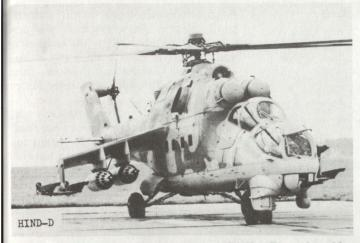
Der Mi-24 HIND-D verfügt über folgende Waffen: Eine schwenkbare, 4-läufige 12,7-mm-Gatling-Kanone im Kinnturm, max. 4 Behälter UB-32-57 mit je 32 Abschussrohren für total 128 ungelenkte Raketen vom Typ S-5, verschiedene Spreng-/Splitterbomben und Submunitionsbomben, C-Kampfstoff-Behälter, Luftverminungsbehälter, je 4 Panzerabwehrlenkwaffen AT-2 Swatter-B.
