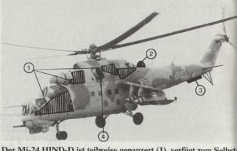
Der Mi-24 HIND-D ist teilweise gepanzert (1), verfügt zum Selbstschutz über ein IR-Stroboskop, d. h. eine IR-Strahlungsquelle (2), Düppel- und Fackel-Ausstossgerät (3), eine Ummantelung der Abgasrohre zur Unterdrückung der Triebwerk IR-Abstrahlung (vgl. das Foto des nach Pakistan geflogenen Mi-24) (4) und ein Radarwarngerät.
