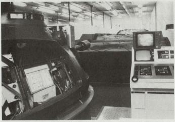
Bild 4. Elektrische Schiessanlage für Panzer (ELSAP 2000). Die Anlage ermöglicht eine sehr wirklichkeitsnahe Schulung aller Schiessverfahren, zwar nur aus dem stehenden Panzer, aber doch für alle Beleuchtungsverhältnisse.
