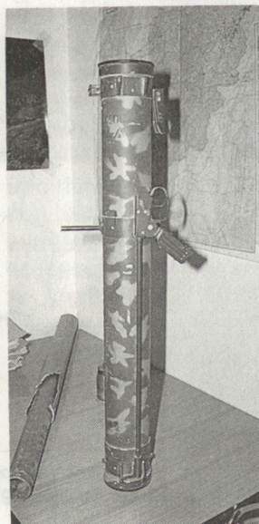
Foto 4: Tragbarer Flammenwerfer RPO / A. Stahel
