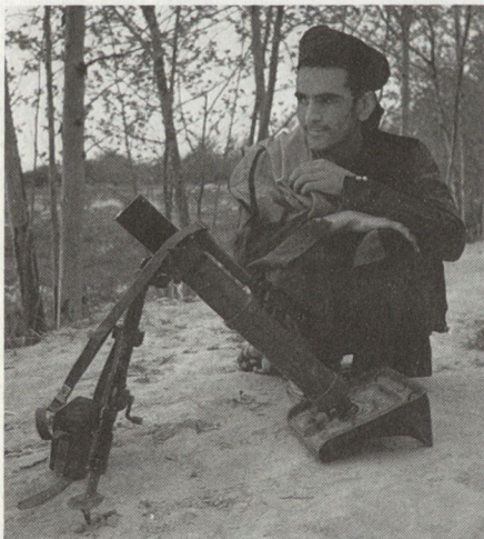
Foto 14: Leichter Minenwerfer 60 mm, Reichweite 1700 m / K. Pelda
