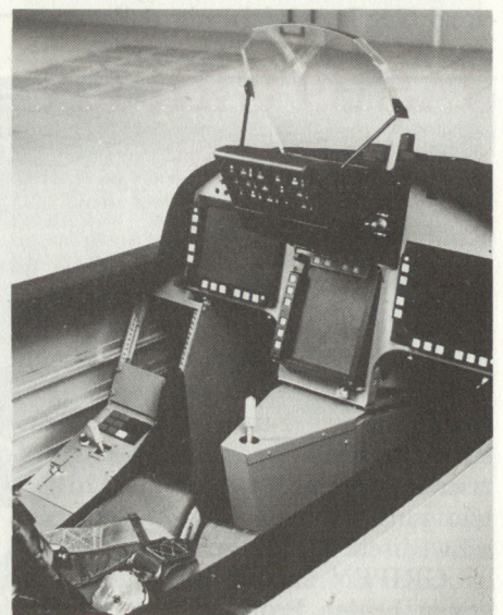
Bild 2. Das GRIPEN-Cockpit sieht verblüffend aufgeräumt und simpel aus. Vor dem «Multi-mode-display» der «Control stick» für die elektrische Impulssteuerung.
