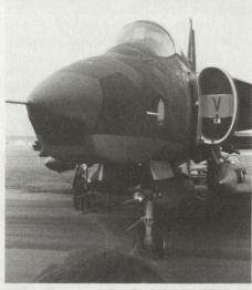
Bild 4: Rumpfnase des Saab SF 37 «Viggen»-Photoaufklärers. Kamerafenster für Frontalaufnahmen vorne, runde Öffnung für Seitenbildaufnahmen. Deutlich sichtbar zwei Behälter für Nachtbildaufnahmegerät, Beleuchtungsvorrichtung und an den Flügelenden je ein ECM-Behälter.
