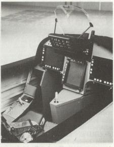
Bild 2. Das GRIPEN-Cockpit sieht verblüffend aufgeräumt und simpel aus. Vor dem «Multi-mode-display» der «Control stick» für die elektrische Impulssteuerung.
