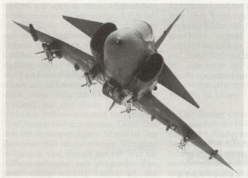
Bild 1: Saab JA 37 «Viggen»-Jagdflugzeug mit 2 radargesteuerten «Skyflash»- und «Sidewinder»-Luft-Lenkwaffen. Für den Luft-nahkampf ist eine 30-mm-Oerlikon-Hochleistungskanone zum Einbau gekommen.
