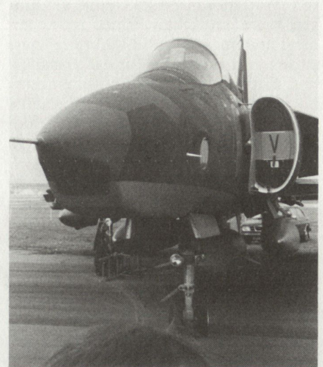
Bild 4: Rumpfnase des Saab SF 37 «Viggen»-Photoaufklärers. Kamerafenster für Frontalaufnahmen vorne, runde Öffnung für Seitenbildaufnahmen. Deutlich sichtbar zwei Behälter für Nachtaufnahmegerät, Beleuchtungsvorrichtung und an den Flügeln je ein ECM-Behälter.
