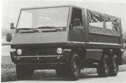
im Jahr 1985 abgelieferten zweiachsigem «Bucher-Puma 4x4» wartet die Firma nunmehr mit der **dreiachsigen Variante «Bucher-Puma 6x6»** auf, die mit **Katalysator** ausgerüstet ist.
