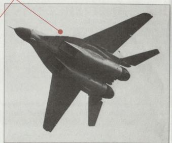
Bild 2. MiG-29 «Fulcrum» beim Hochziehen in den vertikalen Kletterflug. Die Luftschlitze sind geschlossen, die Vorflügel voll ausgefahren. Die Seitenleitwerke befinden sich am Rumpfende und entgehen so den störenden Vortexwirbelströmungen.
