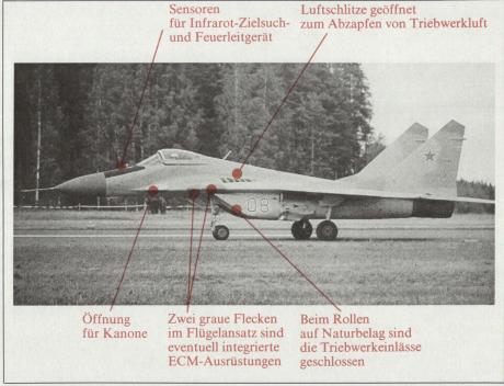
Bild 1. MiG-29 «Fulcrum» im Rollzustand. Die Triebwerkseinlässe sind geschlossen, die erforderliche Luftzufuhr erfolgt durch Schlitze an der Rumpfoberseite.
