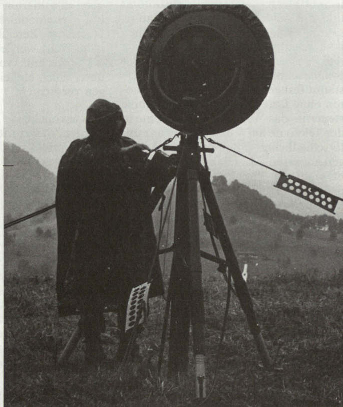
Bild 4. Parabolspiegel der gegenwärtig in Truppenversuchen stehenden Richtstrahlstation R-915. Mit dieser Ausrüstung lassen sich 60 Kanäle im Mikrowellenbereich gleichzeitig übertragen. Hersteller Standard Telefon und Radio AG, Zürich.
