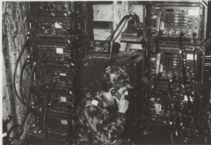
Bild 6. Richtstrahlübertragung im IMFS-90: Mehrere Telefonleitungen werden in der Mehrkanalausrüstung MK-7 (links oben) gesammelt, im Chiffrierzusatz CZ-1 (links unten) verschlüsselt und über die Bedieneinheiten an die Antenne(n) der Richtstrahlstation R-915 weitergeleitet. Hersteller MK-7: Hasler AG, Bern; CZ-1: BBC, Baden.
