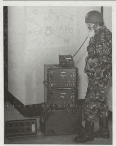
Bild 7. Mögliche Auslegung eines Endvermittlers der Teilnehmerebene für 30 Teilnehmer ausgerüstet. Die Vermittler befinden sich erst in Planung.
