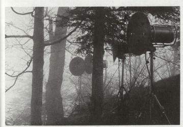
Bild 5. Die Richtstrahlstation R-902 für Digitalbetrieb umgebaut als Zubringer Knoten-Teilnehmerebene für gleichzeitig 15 Kanäle. Hersteller BBC, Baden.
