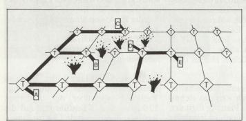
Bild 3. Ausfallsicherheit und automatische Wegesuche nach Teilzerstörung.
