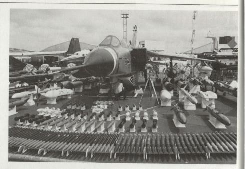
Bild 1. Waffendisplay der Tornado Interdiction-/Strikeversion der Bundeswehr. Unter dem Rumpf sieht man die Hauptbewaffnung, den MW-1 Behälter mit Submunition.
