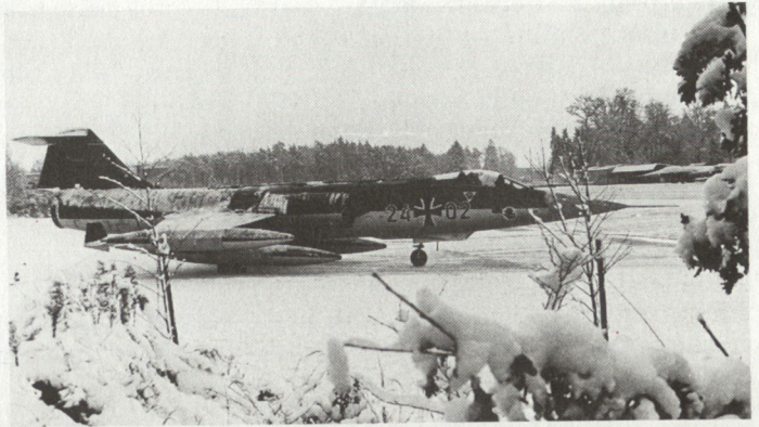
RF-104G des Aufklärungsgeschwaders 51 «Immelmann» im Winter. Hochkomplexe Waffensysteme so Wind und Wetter auszusetzen, erhöht die Störanfälligkeit, vor allem elektronischer Bordsysteme. Durch die Starfighter-Krise wurde beschleunigt zusätzlicher Hallenraum geschaffen. (Archiv AWK)
