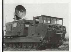
Flugbahnvermessungs- und Feuerleitgerät FIELDGUARD (als FERA in der BRD eingeführt)
