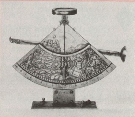
Pendelrichtquadrant mit Bussole (um 1650).
