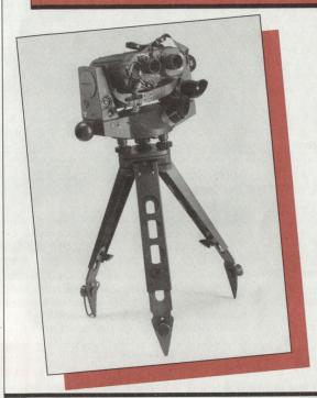
Wild SG4T-1 Goniometer und LP7G Laser Entfernungsmesser (Lizenz Simrad) zusammen ergeben den Laser-Goniometer LA GONIO 85. Dieser ermöglicht eine rasche, exakte Zielbestimmung. So exakt, dass
