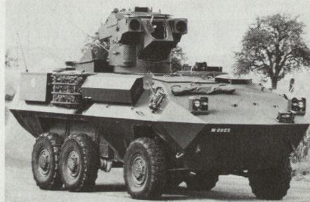
**6x6** ist eine Entwicklung der Firma Mowag AG in Kreuzlingen. Es besitzt drei Achsen mit Einzelradaufhängung und zuschaltbarem Allradantrieb.
