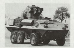
**6×6** ist eine Entwicklung der Firma Mowag AG in Kreuzlingen. Es besitzt drei Achsen mit Einzelradaufhängung und zuschaltbarem Allradantrieb.
