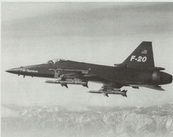
Die F-20 «Tigershark» in der Rolle eines Abfangjägers. Dieses leichte Jagdflugzeug kann sowohl radargesteuerte AIM-7-«Sparrow»- wie AIM-9-«Sidewinder»-Lenk Waffen mit Infrarot-Zielsuchkopf zum Abschuss bringen.
