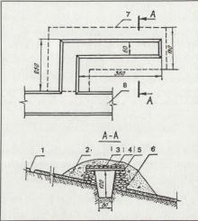
Fig. 3. Überdeckter Deckungsgraben, in gebirgigem Gelände ausgeführt
