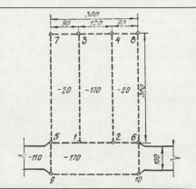
Fig. 2. Abstecken eines überdeckten Grabenabschnitts
