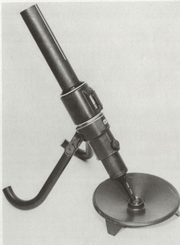
Leichter Granatwerfer für Geschosse zur Gefechtsfeldbeleuchtung.
