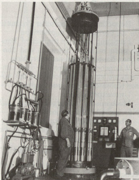
Teil der Gas-Nitrieranlage mit rechnergestützter Prozesssteuerung.
