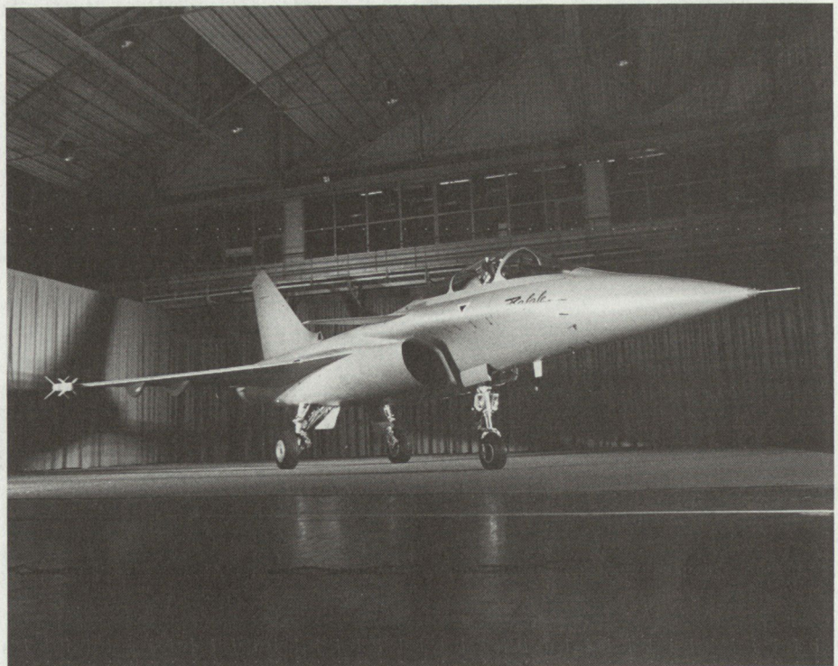
Bild 1. Der Vorserie-Prototyp «Rafale». Vorerst handelt es sich um ein einsitziges Mach-2-Jagdflugzeug von 9,5 Tonnen Leergewicht und zwei amerikanischen General-Electric-F 404-Triebwerken. Die Serienexemplare werden etwas kürzer, dafür um eine Tonne leichter ausfallen und durch französische Snecma M88-Triebwerke angetrieben. Man beachte die Rumpfform zum ungehinderten Anströmen der grossen Triebwerköffnungen.
