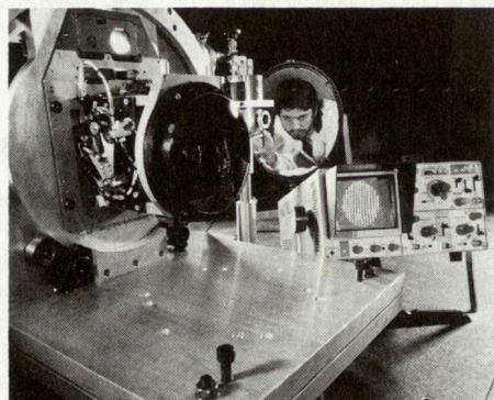
Das Bild zeigt einen Teil eines auf einem Interferometer basierenden Systems zur Prüfung der optischen Güte thermischer Linsen. Ein Laserstrahl wird durch einen Strahlexpander hindurchprojiziert und in einen Prüfstrahl und einen Bezugsstrahl geteilt. Der Prüfstrahl wird durch die zu untersuchende Linse hindurchgeleitet und dann in den Bezugsstrahl zurückgespiegelt,
