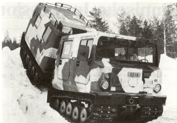
Kettenfahrzeug Bv 206, schwedischer Herkunft. Transportiert 17 Mann oder 2 Tonnen über Schnee oder im Sumpfgelände.
