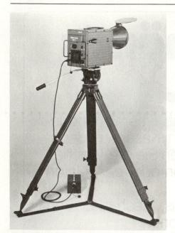
Abb. 10. Wärmebildgerät
