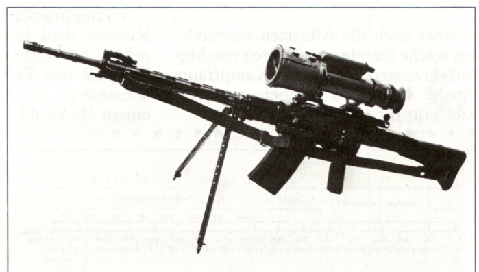
Abb. 8. Restlichtverstärker für Sturmgewehr
