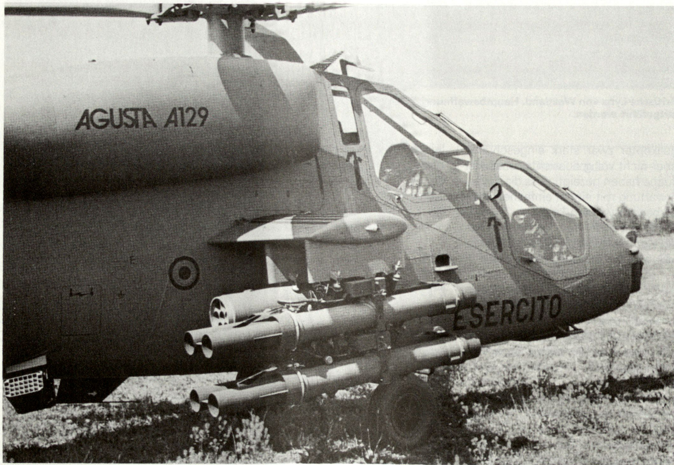
Die italienische Agusta A 129 Mongoose von Agusta-Milano. Bewaffnung: 8 TO/W Lenkwaffen, dazu alternativ Raketen und / oder Mg verschiedener Kaliber.
