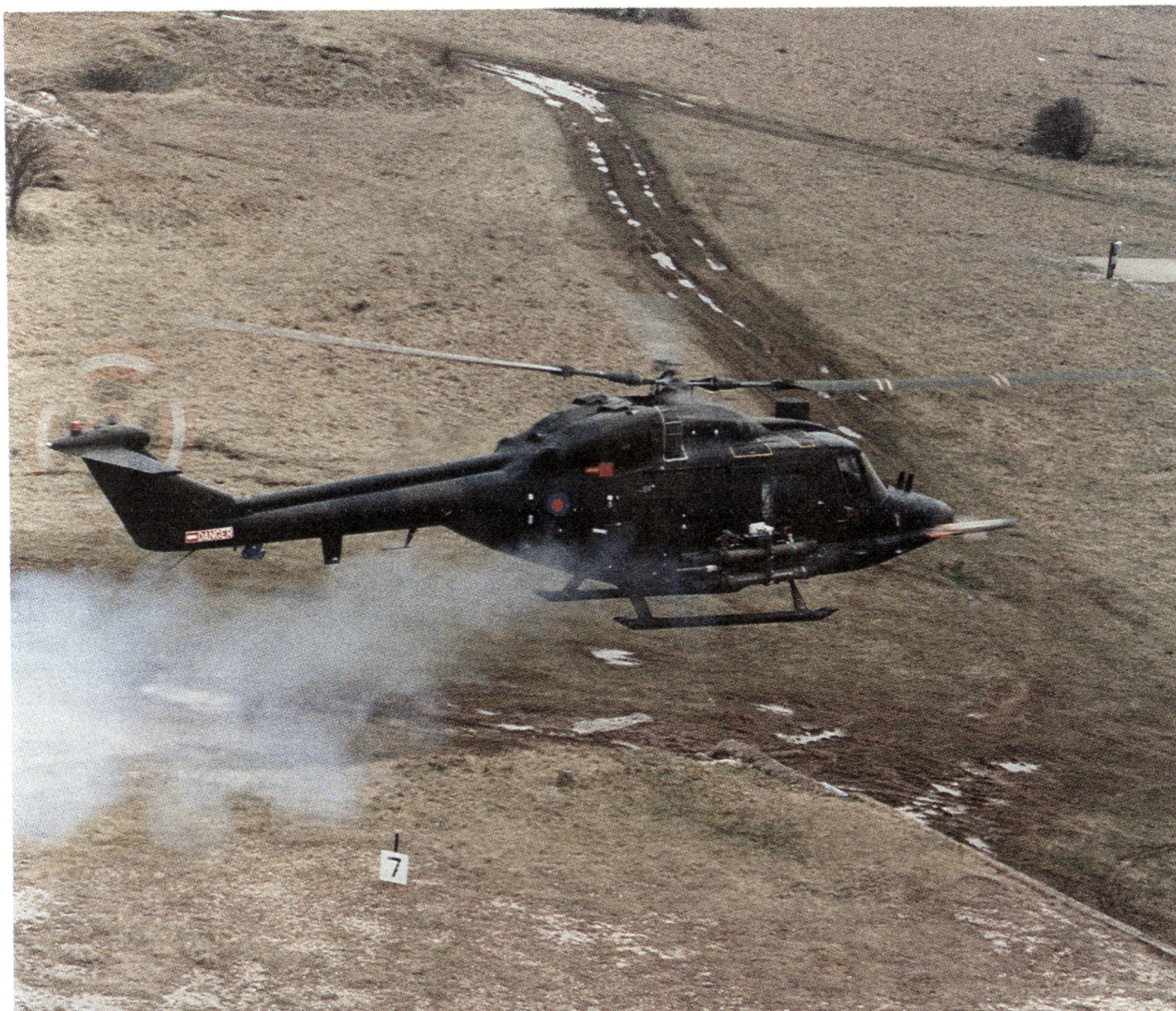
Britische Lynx von Westland. Hauptbewaffnung: 8 TOW- oder Milan-Panzerabwehrwaffen. Ein Reservesatz kann im Frachtraum mitgeführt werden.
