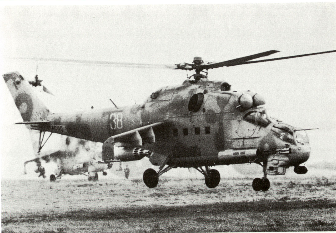
Mi-24 HIND/E mit Zweifachträger für AT-6 Spiral, Raketenbehälter UB-32 und neu rechts am Vorderrumpf angeordneter Behälter mit einer Zwilling-Maschinenkanone 23 mm.
