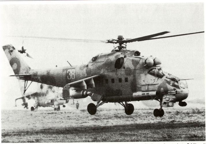
Mi-24 HIND/E mit Zweifachträger für AT-6 Spiral, Raketenbehälter UB-32 und neu rechts am Vorderrumpf angeordneter Behälter mit einer Zwillings-Maschinenkanone 23 mm.
