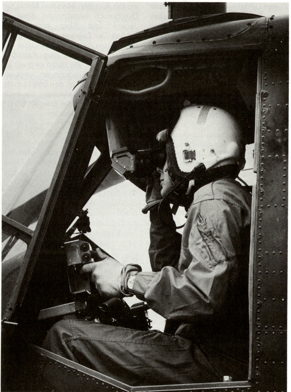
APX M 397 Visiergerät für Milan Panzerabwehrlenkwaffe (Lynx).
