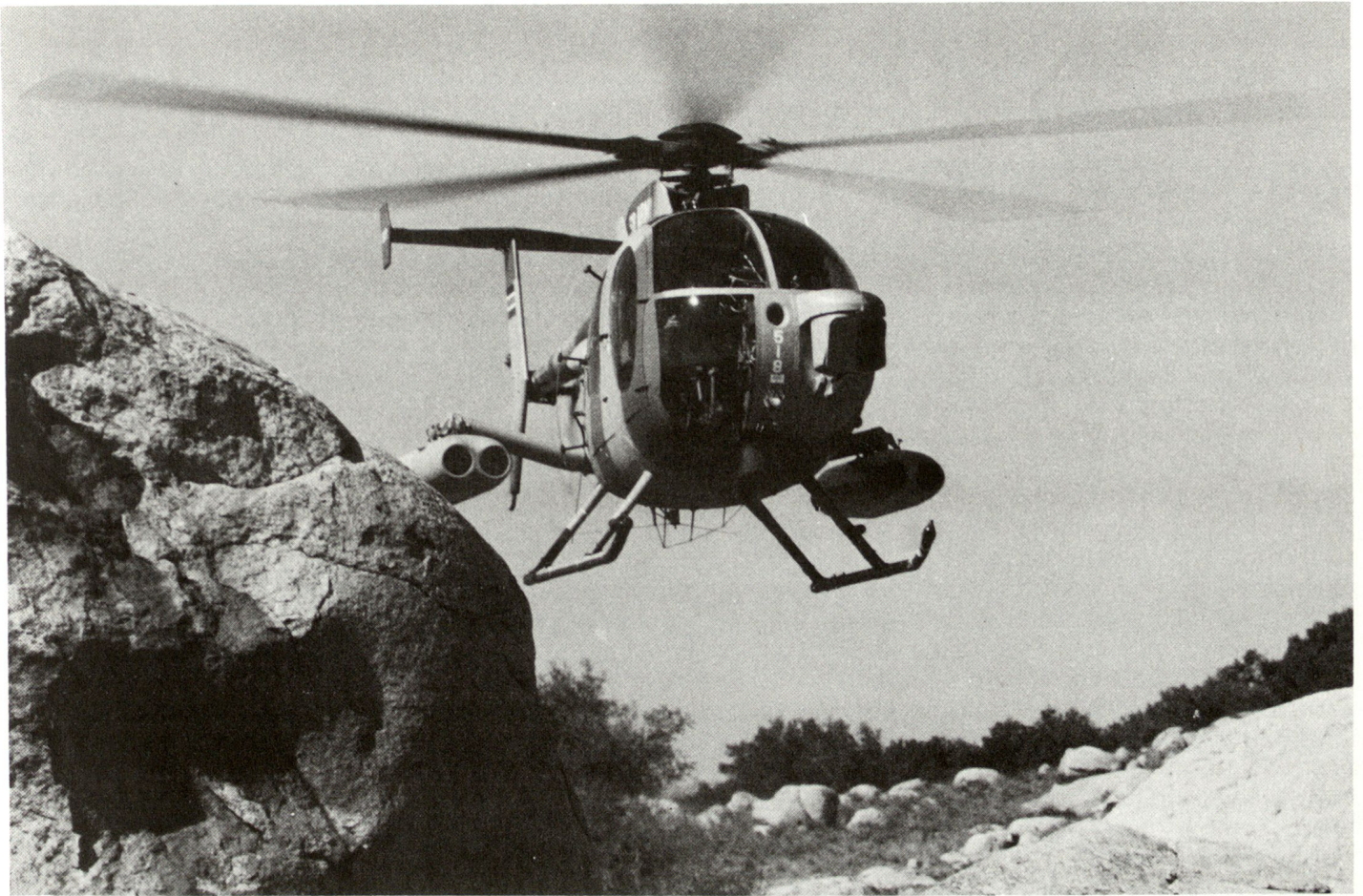
Hughes 500 MD Defender mit TOW Lenkwaffe. Vorne rechts das elektro-optische Zielgerät.
