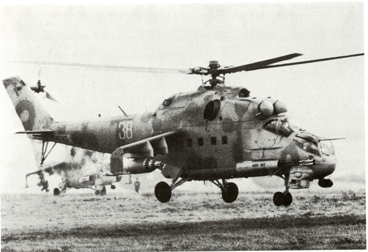
Mi-24 HIND/E mit Zweifachträger für AT-6 Spiral, Raketenbehälter UB-32 und neu rechts am Vorderrumpf angeordneter Behälter mit einer Zwillingen-Maschinenkanone 23 mm.
