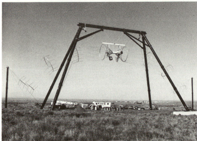
Bild 2: Der grosse, transportable EMP-Simulator (MEMPS) in der Werkerprobungsphase in Albuquerque (USA).
