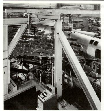
Ermüdungsversuch mit einer Mirage III im Eidgenössischen Flugzeugwerk Emmen. Die im Flug auftretenden Belastungen werden wirklichkeitsgetreu nachgebildet. Dabei werden Tausende von Flugstunden simuliert. In der Struktur des Mirage-Flügels wurden so rechtzeitig Materialermüdungen mit Rissbildungen erkannt. Dies ermöglichte, kostengünstige Sanierungsmassnahmen in die Wege zu leiten.
